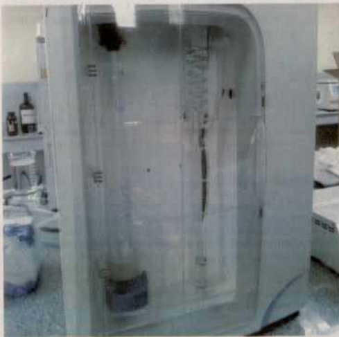
Figura 1. Foto equipo Kjeldahl ubicado en el laboratorio de suelos de la Facultad de Ciencias de la Universidad Agraria del Ecuador
